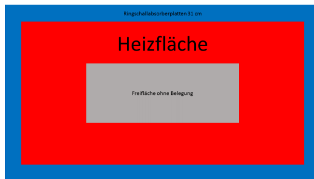
Deckensegel außenliegend mit Ringschallabsorberplatten
