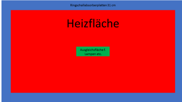
Maximale Heizleistung mit Ringschallabsorberplatten
